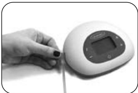
3. Insira o conector da Bomba na abertura do lado esquerdo da Bomba.
